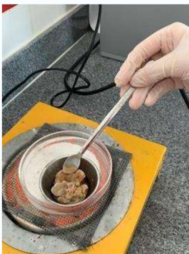
Fig 3. Derretimento da cera de abelha que ao ser misturada com a glicerina natural forma a camada impermeável.
