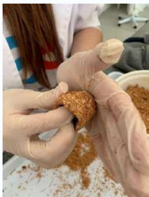
Fig 1. Composição do bioplástico juntamente com a fibra do coco, etapa de modelagem e arredondamento do objeto.
